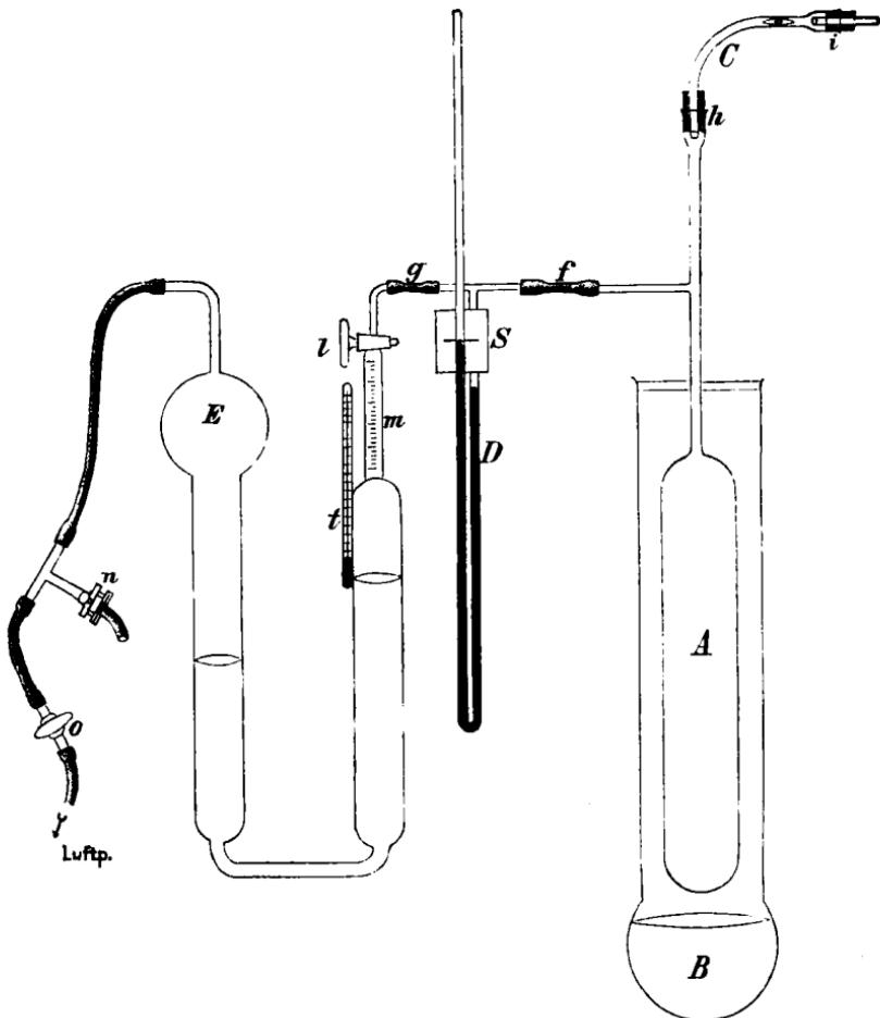
durch Erhitzen von *A* entsteht, schliesst man den Hahn *o* und bringt die Heizflüssigkeit *B* zum Sieden. Sind die Dämpfe über *A* hinaus, so regulire ich die Flamme, bis das Manometer und das Wasser in der U-Röhre einen festen Stand (für den Verlauf von 2—3 Minuten) zeigen. Dies wird controlirt durch den Spiegel *S* mit eingeritzter oder getuschter, feiner Marke, sowie durch den Wasserstand im U-Rohr. Ein oder zwei
